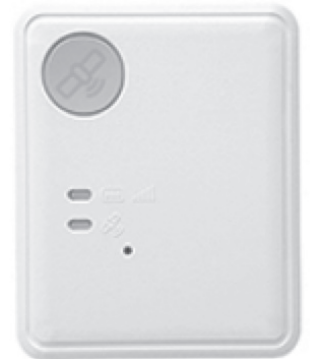
端末機実物 (縦47.5mm・横38.5mm・厚さ11.85mm)
